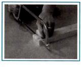
4 - Couper l'un des côtés d'un croisillon d'extrémité pour former un L et l'installer dans le cadre, en bas à gauche. Faire de même en bas à droite.
